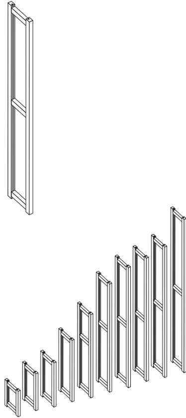
Seitenverkleidungen können in die offenen Ständer eingebaut werden. Die Seitenverkleidung ist im Preis der Ständer nicht inbegriffen. Die Breite eines offenen Ständers beträgt 36 mm. Türelemente mit einer Höhe von 100 cm können bei 218 cm hohen Regalfeldern aus konstruktiven Gründen nicht im unteren Bereich des Regals eingebaut werden.
