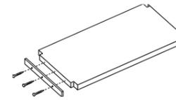
Die aus Flachstahl gefertigten Trageschienen sind 15 x 2 mm groß und werden mit den Fachböden verschraubt. Mit diesen Schienen sind Fachbodenkürzungen möglich. Bei Verwendung der Trageschienen gelten die Angaben zur maximalen Traglast der Böden nicht mehr. Die Befestigungsschrauben mit der Länge von 25 mm sind im Lieferumfang inbegriffen.
