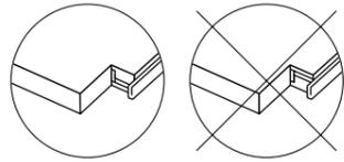
Die Enden der Lundia-Fachböden sind mit Winkelschienen verstärkt, die ein Ausreißen verhindern und die Tragkraft erhöhen. Bei der Montage der Fachböden ist die Ober-/Unterseite der Fachböden zu beachten.
