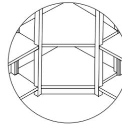
Eckböden sind dazu da, ein Regal über Eck zu planen oder um das Regal optisch angenehm abzuschließen. Dazu wird die Konstruktion auf der einen Seite mit einem 30 cm tiefen Ständer, auf der anderen mit einem 60 cm tiefen Ständer verbunden.
