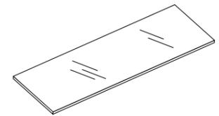
Die Glasböden sind aus 6 mm starkem, kantengeschliffenem Glas. Die Lieferung erfolgt inklusive Glasbodenträgern. Zur Stabilisierung sind in einem Regalfeld neben Glasböden auch Holzfachböden zu verwenden. Bei höheren Regalen empfehlen sich Holzeinlegeböden im Abstand von maximal 100 cm. Bei gleichmäßiger Gewichtsverteilung beträgt die maximale Traglast eines Glasbodens 10 kg.
