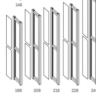
Die Seitenverkleidung wird zwischen die Regalständerriegel und Tragepfote montiert. Die Beschläge zur Befestigung der Seitenverkleidungen sind im Preis enthalten. Bei den höheren Ständern werden pro Ständer jeweils zwei Seitenverkleidungen benötigt.
