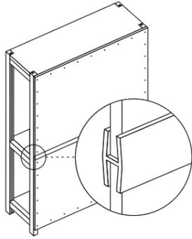
Die Systemrückwände werden mit den mitgelieferten Nägeln befestigt. Übereinander angeordnete Rückwände werden mit Systemrückwandleisten verbunden.
