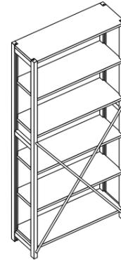
Für eine ausreichende Seitenstabilität der Regale müssen Stabilisierungsscheren oder Systemrückwände in mindestens jedem zweiten Regalfeld eingesetzt werden.
