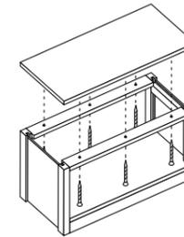
Liegt eine Abdeck-/Tischplatte auf einem Ständer auf, ersetzen die Fixierungsleisten den obersten Fachboden. Dazu wird die Tischplatte von unten mittels Schrauben mit beiden Fixierungsleisten verbunden. Bevor die Tischplatte mit den Fixierungsleisten verbunden werden kann, müssen zunächst die Stützleisten unter der Abdeck-/Tischplatte entfernt werden.
